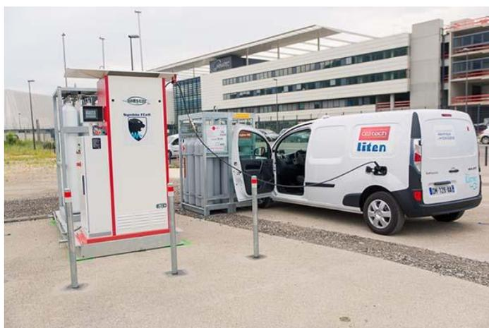
Fig. 5 : Recharge d'une Kangoo ZE-H2. Le réservoir du véhicule est situé derrière le siège conducteur sous le plancher et occupe donc un volume limité dans l'habitacle –Source : Symbio
