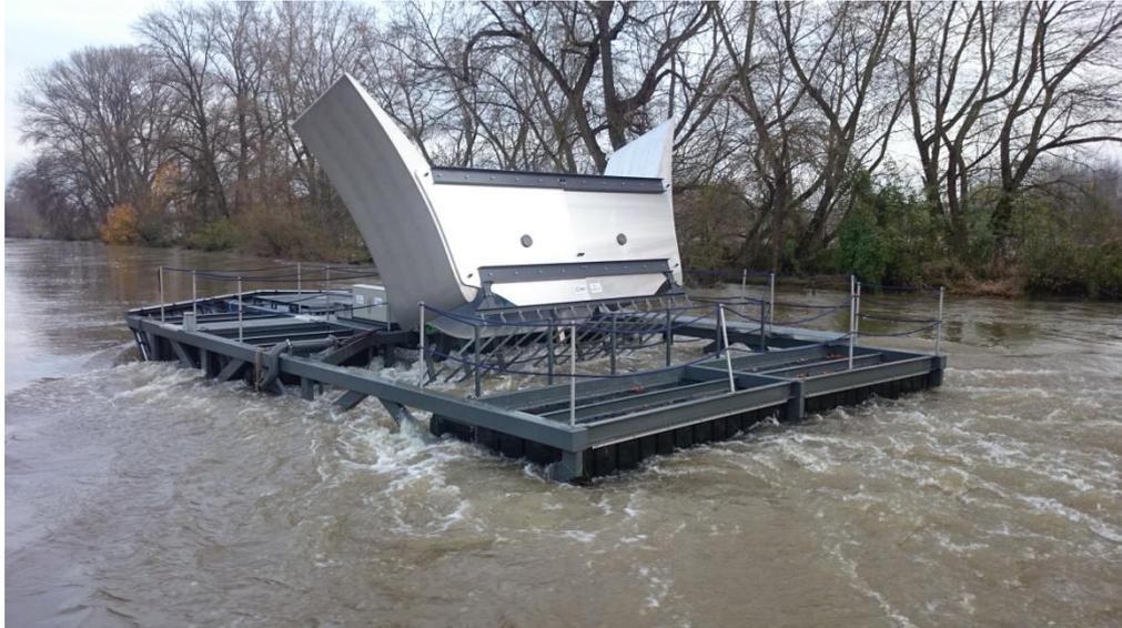
**Fig. 3 : Hydrolienne partiellement immergée à Orléans – source : Hydroquest**
