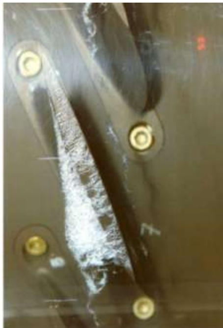
**Fig. 5 : Cavitation à poches sur un entrefer de roue**
