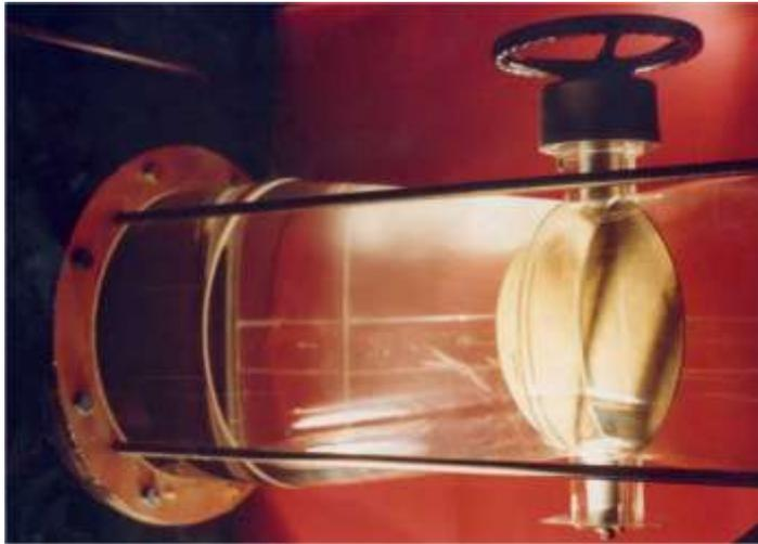
Fig. 9 : cavitation de mélange en aval d'une vanne papillon
