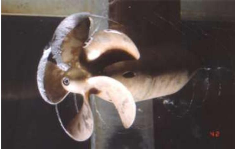
Fig. 6 : cavitation à lames sur une pale d'hélice
