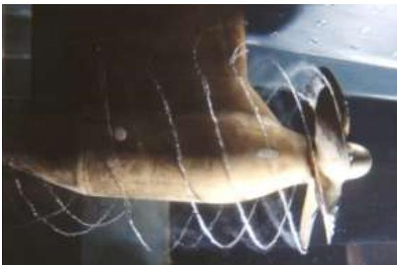
Fig. 7 : cavitation d'extrémité de pale d'hélice
