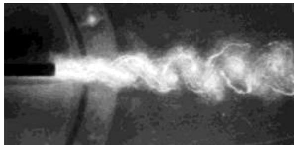
Fig. 8 : tourbillons cavitants en aval d'un obstacle
