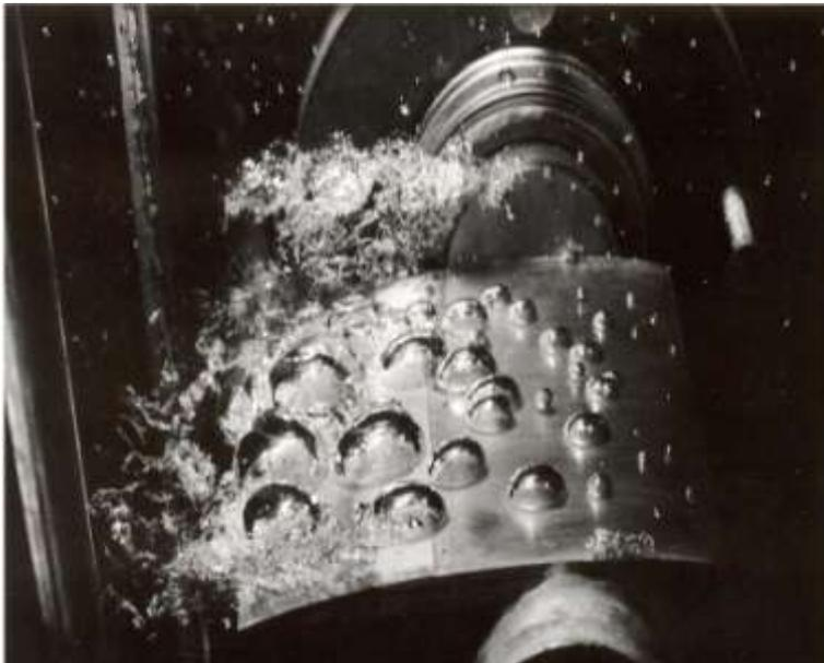
**Fig. 2 : cavitation à bulles sur un profil d'aile**
