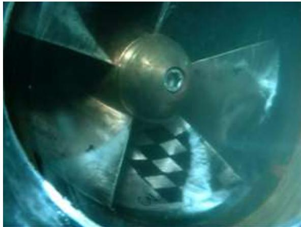
**Fig. 4 : Cavitation à poches sur une roue de pompe**
