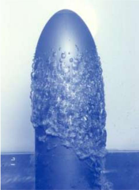
**Fig. 3 : Cavitation à poches sur un engin sous-marin**
