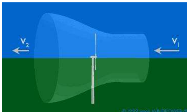
Fig. 5 : Schéma d'écoulement de l'air dans une éolienne à axe horizontal non carénée. - Source : www.winpower.org
