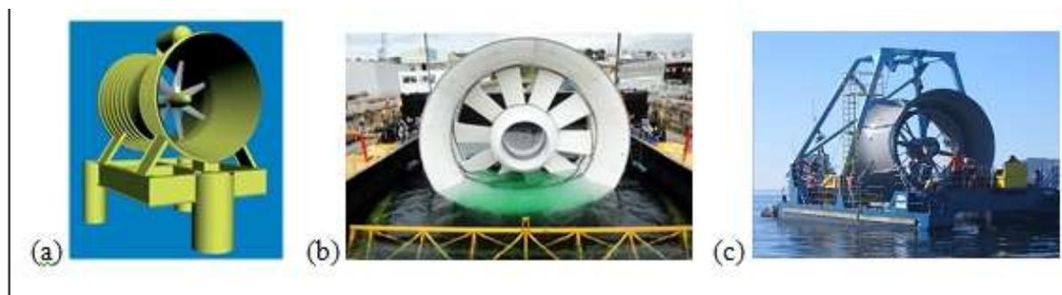
Fig. 8 : Turbine carénée à flux axial a) Lunar Energy UK, b) EDF-Openhydro Fr., c) Alstom/Clean-Current Fr.
