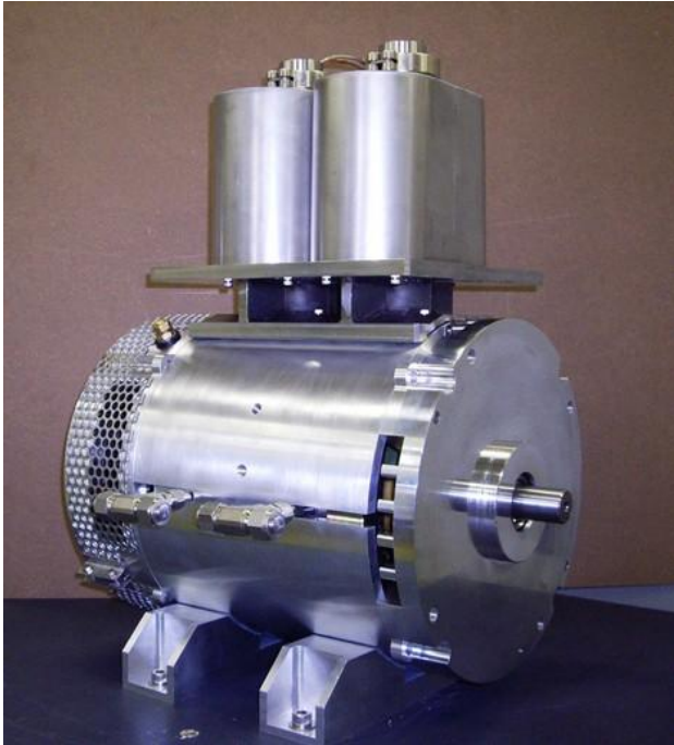
Fig. 5 : Moteur supraconducteur Sumitomo – source : Leblogauto.com
